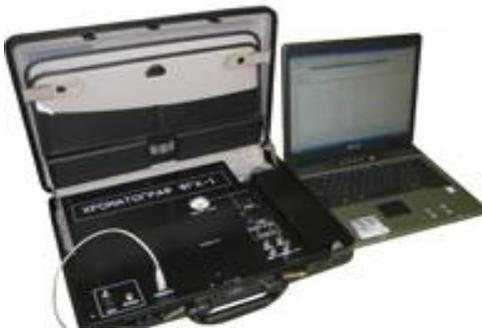
Рис.1. Фотография общего вид хроматографа газового портативного ФГХ.
